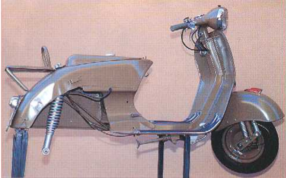
• La scocca di una Vyatka in fase di restauro. Lo spessore della lamiera è leggermente superiore a quello della Vespa contemporanea (1,4 contro 1,2 mm). Uguali invece il numero di parti che la costituiscono (9). Le saldature sono vistosamente grossolane, in special modo nella zona anteriore, all'unione tra lo scudo e il "coperchio" del canotto di sterzo.
